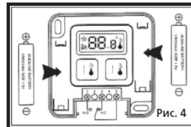
3.2.5. Вставьте в термостат две щелочные батареи типа AAA 1,5В. Схема установки батареи указана на рис. 4.
