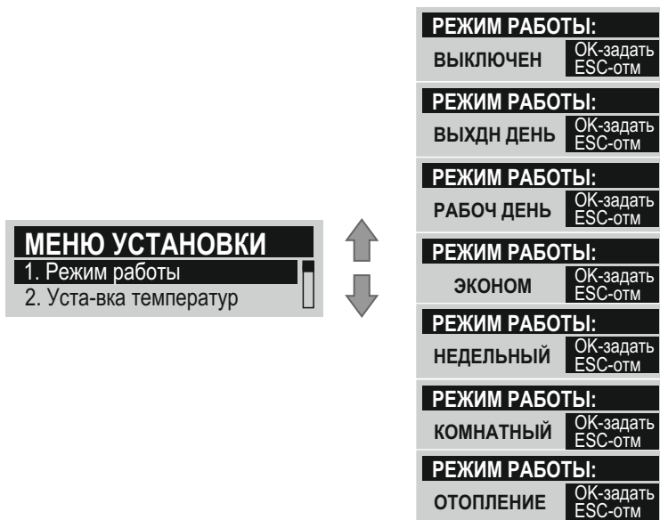
Рисунок 27. Отображение на экране режимов работы прибора.
