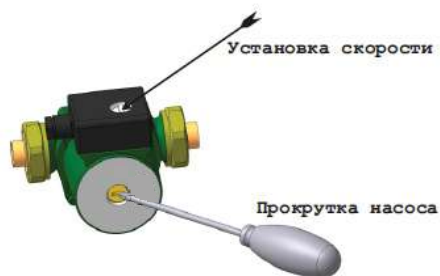
Рисунок 36. Схема обслуживания насоса.
