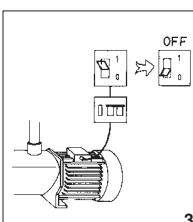
**E** Conecte la electrobomba a la red mediante un interruptor omnipolar (que interrumpe todos los hilos de alimentación) con una distancia de apertura de los contactos de al menos 3 mm.
