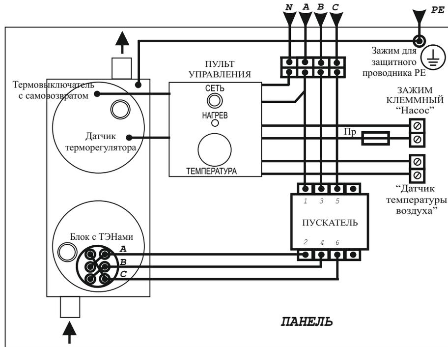
Рисунок 6. Электрическая схема подключения
