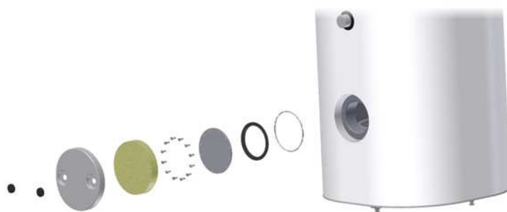
Рис. 11 Монтаж крышки смотрового отверстия (монтажная очередность)
