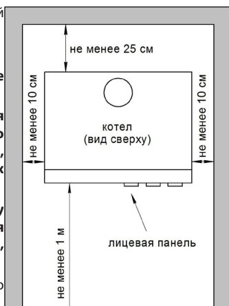
Рис. 5 – Схема установки котла
