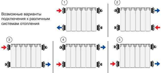
*! При установке радиатора в однотрубной системе отопления перед радиатором необходимо установить байпас (перемычку)*
